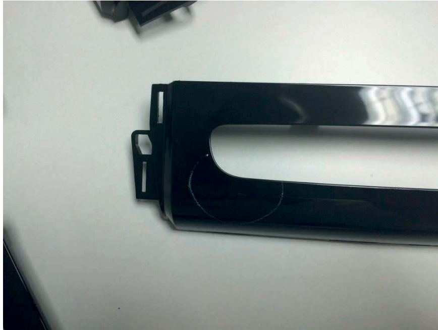
Figure 20: Défaut de brulure
