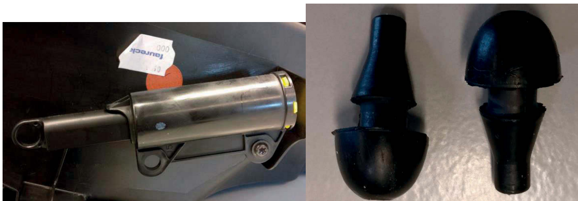
Figure 15: Photos du ralentisseur et des deux butées
